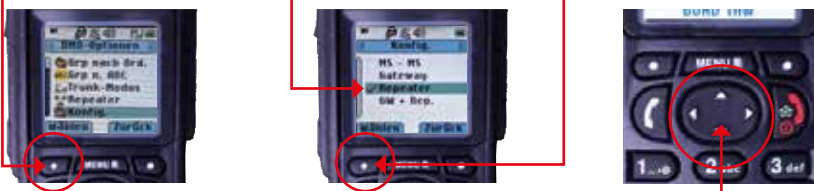
Abb. 59: DMO-Repeater beim HRT nutzen
