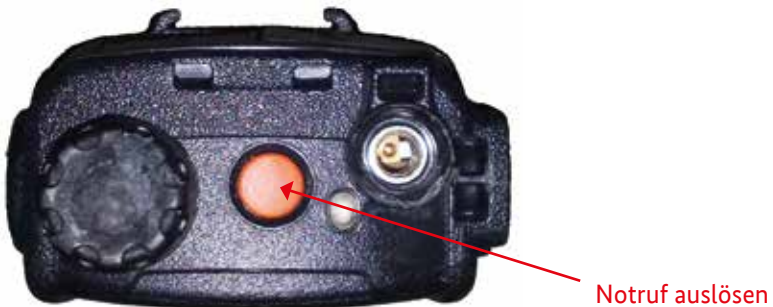
Abb. 50: Notruf beim HRT auslösen
