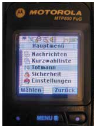
Abb. 58: Menüanzeige zur Auswahl der Totmannschaltung
