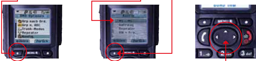
Abb. 61: Gateway-/Repeater-Nutzung beim HRT beenden
