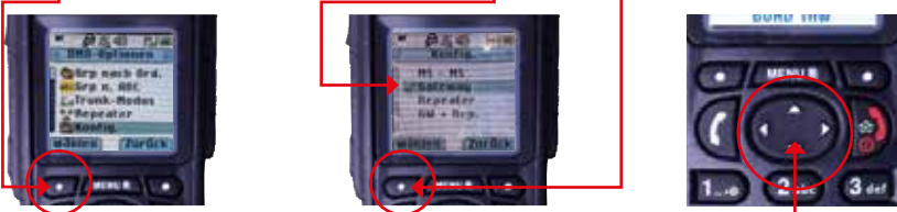
Abb. 60: DMO-TMO-Gateway beim HRT nutzen
