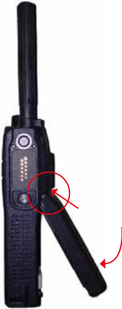
Abb. 48: Akkuwechsel beim HRT 3
