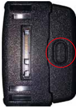
Abb. 46: Akkuwechsel beim HRT 1
