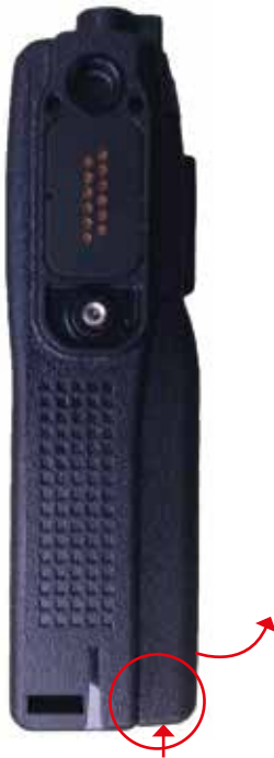
Abb. 47: Akkuwechsel beim HRT 2
