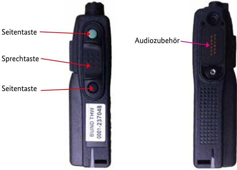
Abb. 37: Bedienelemente des HRT, Seitenansicht
