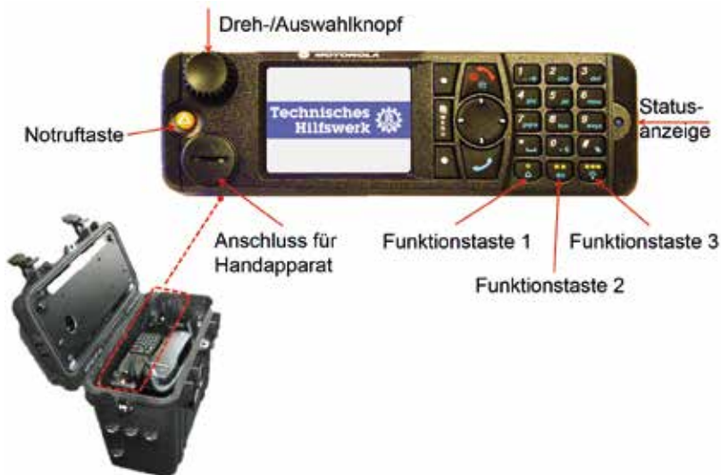
Abb. 31: Mobile Radio Terminal und Verbau in Koffer
