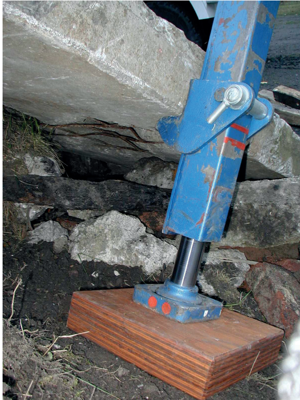
Abb. 65: Büffel anheben mittels Klaue
