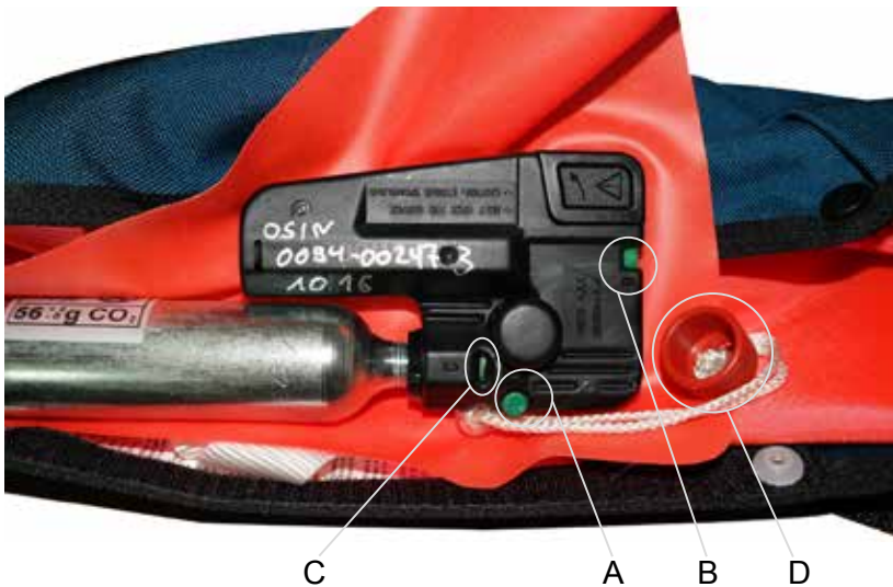
Abb. 13: THW-Rettungsweste „Golf 275“ – Prüfung der Funktionstüchtigkeit
