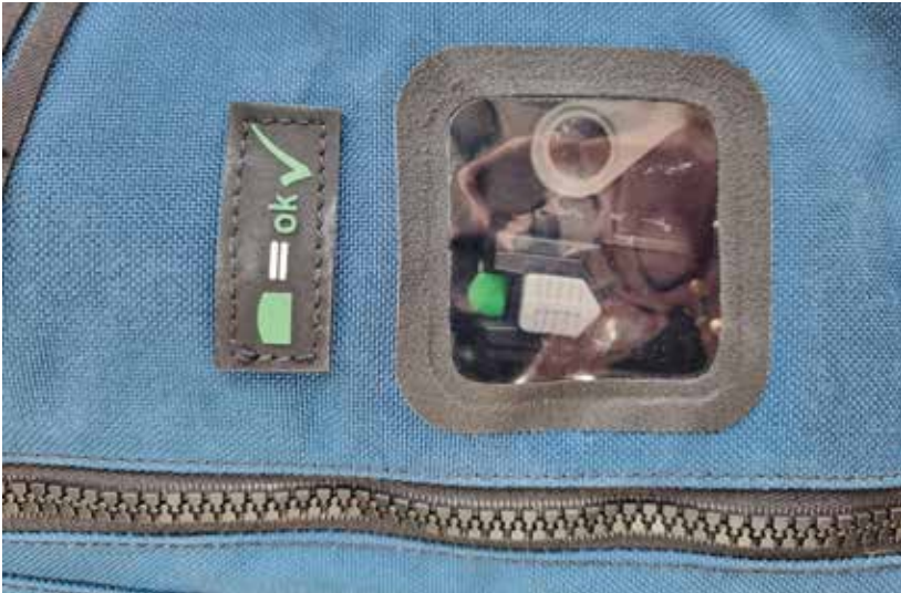
Abb. 15: THW Rettungsweste „Sierra 300“ – Prüfung der Funktionstüchtigkeit
