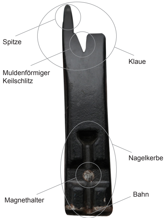
Abb. 109: Aufbau Latthammer
