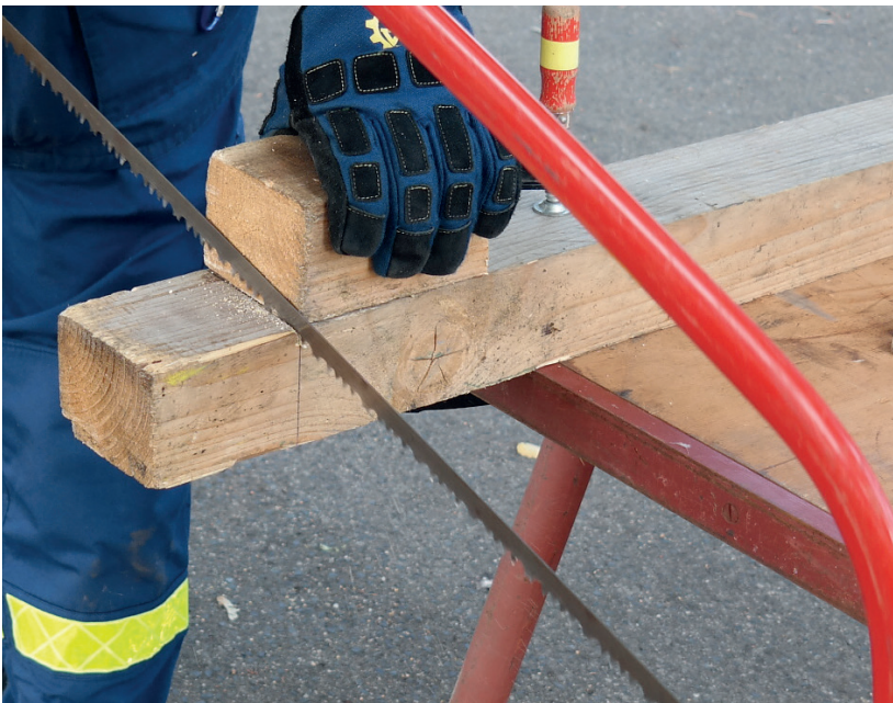
Abb. 113: Ansägen mit Führholz
